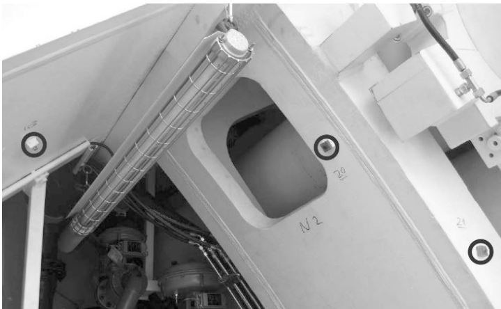
Abb. 2: Lage der Passpunkte im hinteren Teil einer Tunnelbohrmaschine
